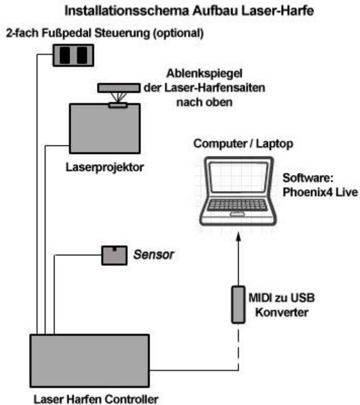
Achten sie darauf dass der Sensor in einem günstigen Winkel (ca. 45 Grad) zur Ausgabe der Laser-Harfensaiten steht.
