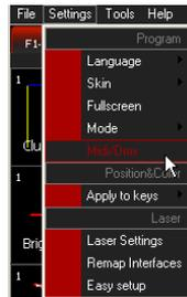
Aktivieren Sie anschließend die MIDI-In Funktion in der Software. Öffnen Sie die Phoenix4 Live MIDI/DMX Einstellungen über das obere Menü „Settings>MIDI/DMX“.
